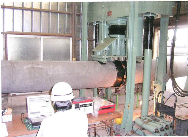
杭の曲げ試験
